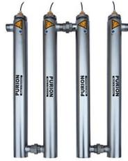
Die Prozesslufteinheit besteht aus vier Reaktoren PURION 2501, welche in Reihe zu installieren sind. Die eingeleitete Luft wird durch die Reaktoren geführt und entkeimt. Die Prozesslufteinheit kann einfach in Rohrleitungssysteme, auch nachträglich, integriert werden. Die Steuerung ist integriert in einen Schaltkasten, der wahlweise pulverbeschichtet oder in Edelstahl ausgeführt werden kann.
