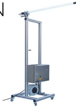
Das Gerät AIRPURION mobile SINGLE besteht aus einer PURION UV-Lampe mit Splitterschutz, welche auf einem robusten, fahr- und schwenkbaren Gestell montiert ist. Die Desinfektionseinheit kann mit einer Fernbedienung an- und ausgeschaltet werden. Das Gerät eignet sich hervorragend für die Desinfektion in bestehenden Reinraumanlagen.
