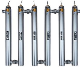
Die Prozesslufteinheit besteht aus sechs Reaktoren PURION 2501, welche in Reihe zu installieren sind. Die eingeleitete Luft wird durch die Reaktoren geführt und entkeimt. Die Prozesslufteinheit kann einfach in Rohrleitungssysteme, auch nachträglich, integriert werden. Die Steuerung ist integriert in einen Schaltkasten, der wahlweise pulverbeschichtet oder in Edelstahl ausgeführt werden kann.
