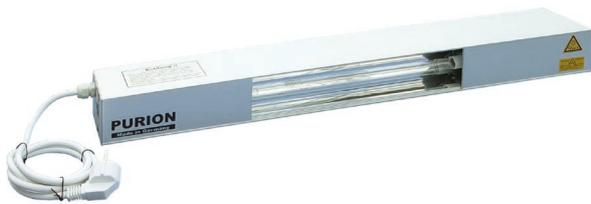
Das System AIRPURION 48 mit einer Bestrahlungsbreite von 380 mm besteht aus einem matt eloxierten Aluminiumprofil mit passenden Abdeckblechen. Das Strahlerfach ist mit einem Reflektor aus reinst poliertem Aluminium ausgelegt. Im rückseitigen Teil befinden sich die Verkabelung und das elektronische Vorschaltgerät. Die hohe Strahlungsintensität sichert bei kompakter Bauweise einen hohen Wirkungsgrad.
